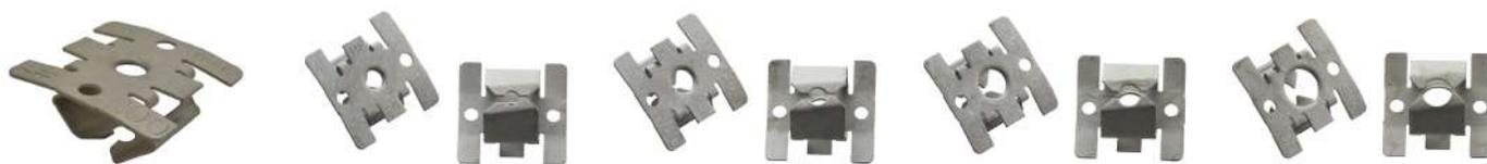
Le QCN allie les propriétés uniques de l'acier ressort avec la technologie de « montage par pression » afin de créer un écrou rail à clipser, permettant une installation de tige filetée ou boulon en quelques seconds. A utiliser avec un contre-écrou sur tige filetée pour l'installation de trapèzes préfabriqués ou avec des boulons à tête ronde pour la fixation murale de boîtiers électriques et autres accessoires.
