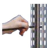
Transformation de l'extrémité en crochet
