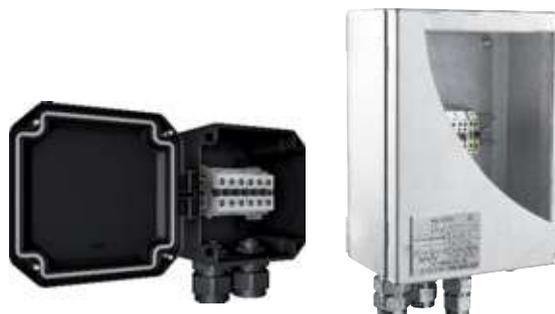
Ces enveloppes doivent avoir un niveau IP54 minimum. Les paramètres électriques sont définis par les échauffements et les distances dans l'air et lignes de fuites, ces dernières étant différentes des celles définies dans les autres normes industrielles. La qualité du raccordement est primordiale dans la protection des matériels de sécurité augmentée.
