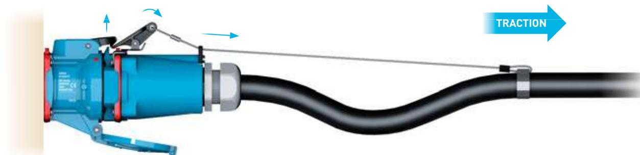
Étape 2 : la traction agit sur le câble électrique et le filin. Le doigt d'éjection relève progressivement le crochet.
