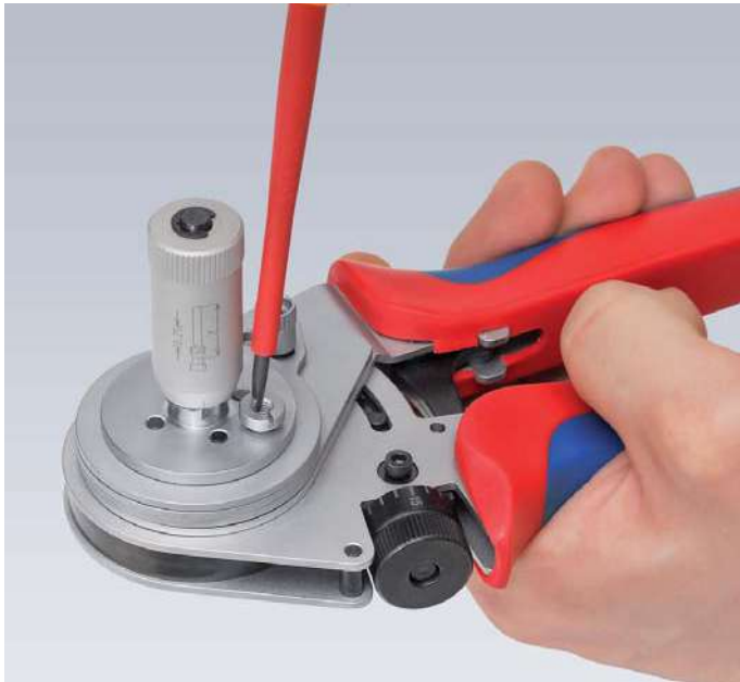
Positionneur 97 59 65 2 pour pinces à sertir 4 points; ajustable en longueur et en diamètre pour différents connecteurs
