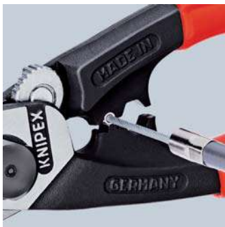
Sertissage de l'embout sur le câble tracteur
