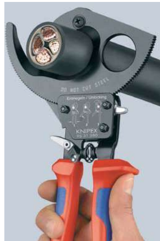
Principe du cliquet et entraînement par couronne dentée à 2 positions pour une coupe moins fatigante
