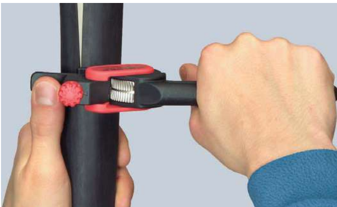
Tourner l'outil pour réaliser une coupe circulaire
