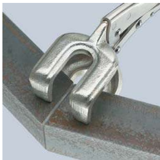
42 14 280 Mâchoires en acier coulé thermorésistant maintient les pièces plates ou profilées les unes à côté des autres lors du soudage convient également pour les profilés ayant des bords d'une hauteur max. de 25 mm
