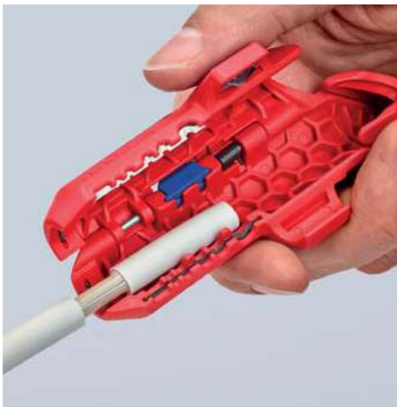
Dégainage d'un câble NYM
