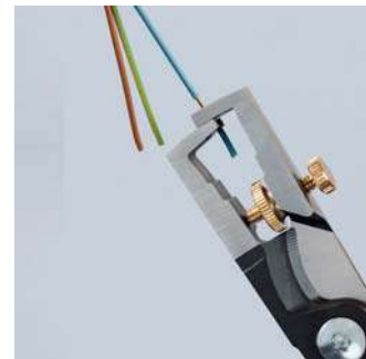
Repères de longueur : Repères visuels aidant au dénudage répété de longueurs usuelles (11 et 16 mm)
