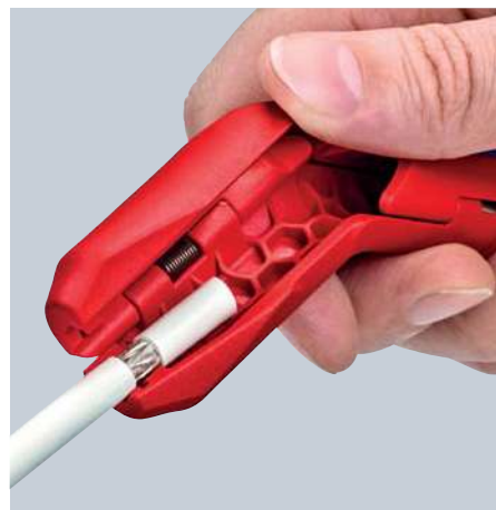
Dégainage d'un câble coaxial
