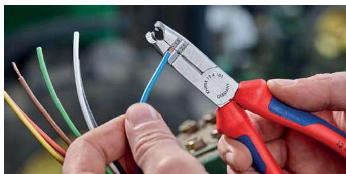
Trous de dénudage pour conducteurs 1,5 et 2,5 mm 2
