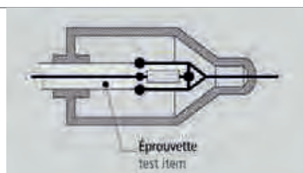
VDE 0245 Résistance de liaison VDE 0245 Surface transfer
