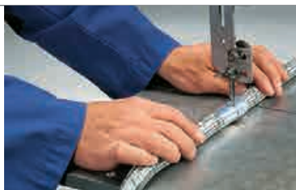
Couper à angle droit par rapport à la lame de la scie en exerçant une légère pression Position conduit at right angle to the band saw and carefully cut through the conduit
