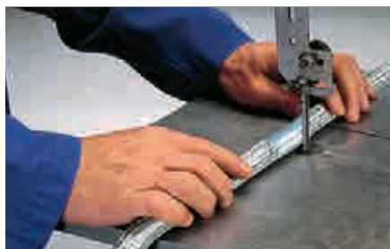
Enrober 2-3 fois la position de coupe de ruban adhésif pour métaux Bind conduit with metal adhesive tape at the cutting position 2 or 3 times
