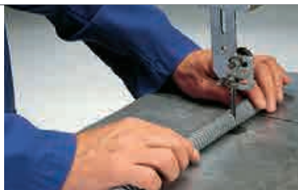
Positionner le tuyau à angle droit par rapport à la lame de la scie Cut conduit with low pressure on the conduit
