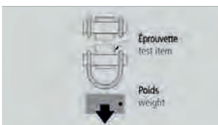
Essais selon les normes UL | CSA Tension test UL 360
