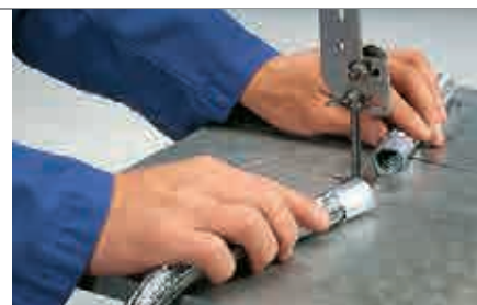
Coupe propre sans chanfrein grâce à l'enrobage de ruban adhésif pour métal Conduit ends are clean without splaying, due to adhesive tape binding
