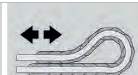
Essai de mouvement des chaînes de guidage avec tuyaux de protection élec-triques intégrés selon la norme Flexa 1044 Motion test guiding chain with integrated elec-trical protective tubing acc. to Flexa norm 1044
