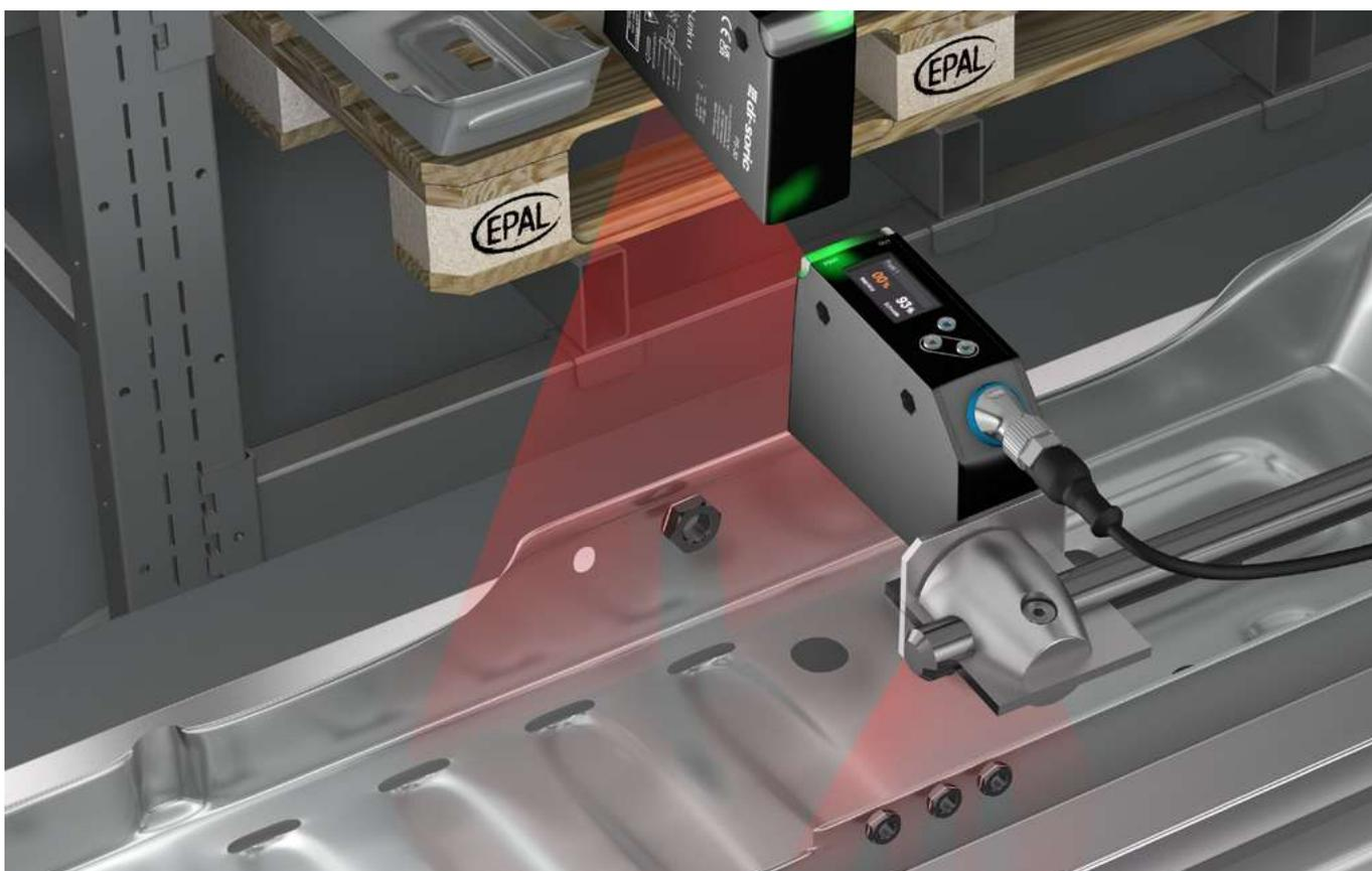
Les capteurs de profil comparent le profil de l'objet contrôlé avec un profil de consigne appris, à l'aide de la méthode de section lumineuse.
