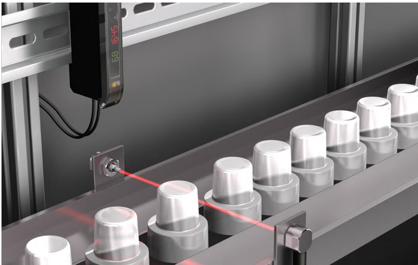
Nos détecteurs à fibres optiques en plastique sont utilisés dans les endroits où de petits objets doivent être détectés et où l'espace de montage est limité. Grâce à une gamme modulaire de fibres optiques et d'accessoires, ils peuvent être adaptés aux différentes applications. Pour le montage sur rail, les amplificateurs pour fibres optiques peuvent être juxtaposés à loisir.
