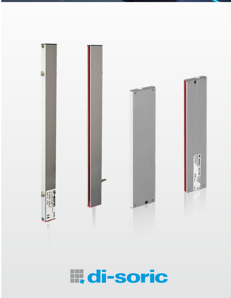
Nos rideaux lumineux détectent et mesurent des objets sur une grande plage de détection et de mesure. Ils fonctionnent sur le principe de plusieurs détecteurs barrages dont les signaux de sortie sont liés les uns aux autres (rideaux lumineux de commutation) ou évalués individuellement (rideaux lumineux de mesure). Grâce à leurs différentes résolutions et hauteurs, ils peuvent être utilisés pour de nombreuses applications.
