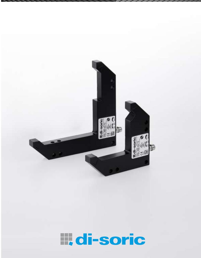
Les fourches optiques angulaires fonctionnent selon le principe du barrage. Elles sont utilisées pour détecter rapidement les objets, quelle que soit leur surface, principalement là où l'espace est restreint. Comme l'émetteur, le récepteur et les éléments électroniques se trouvent dans un boîtier, ils sont rapides à monter. Plus besoin de s'évertuer à monter des fixations ou de perdre son temps à calibrer l'appareil.
