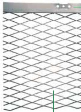
Bande latérale de 42 mm avec trous et encoches pour raccordement du conducteur par boulon ou connecteur CP-95 (connexion recommandée).
