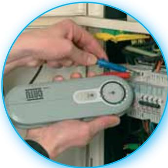
Le DT-500 permet de shunter la phase et le neutre afin de protéger les appareillages fragiles (électroniques, informatiques, ...).
