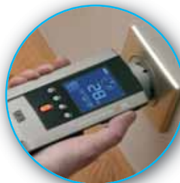
Contrôle sur prise 2P+T.
