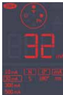
Exemple de mesure de déclenchement d'un DDR de 30 mA non conforme (valeur de courant > au seuil).
