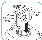
Raccordement des ERIFLEX® FLEXIBAR avec les connecteurs FLG 250 A
