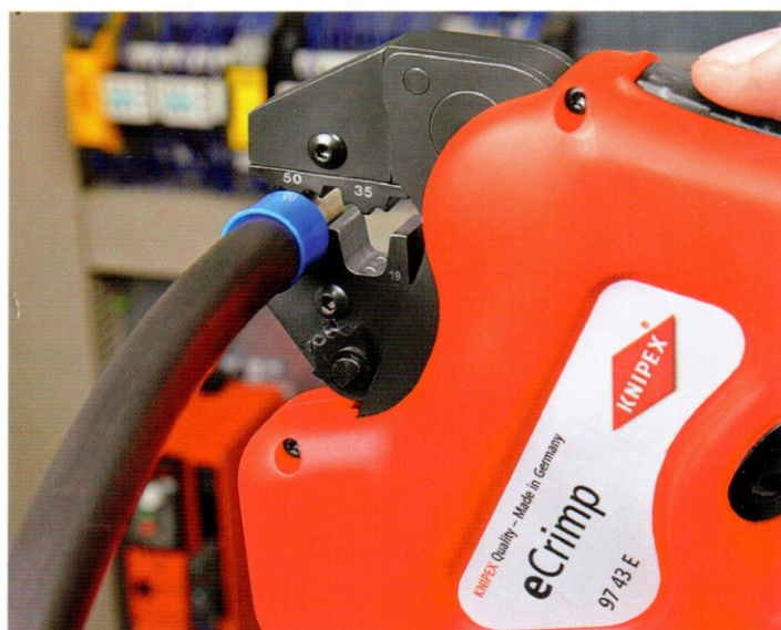
Sertissage d'un embout de 50 mm 2
