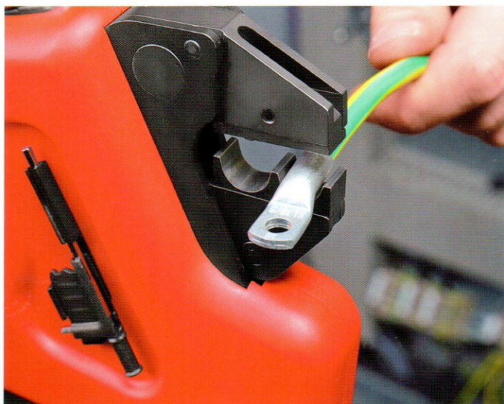
Sertissage d'une cosse de 25 mm 2
