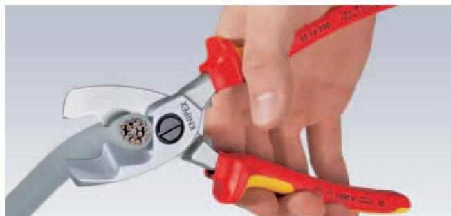
**Coupe définitive:** pour disposer d'une plus grande force, repositionner le câble dans le profil de coupe sur la charnière. Coupe préliminaire à l'avant – coupe définitive à l'arrière afin de garder l'effort de coupe le plus facile possible.
